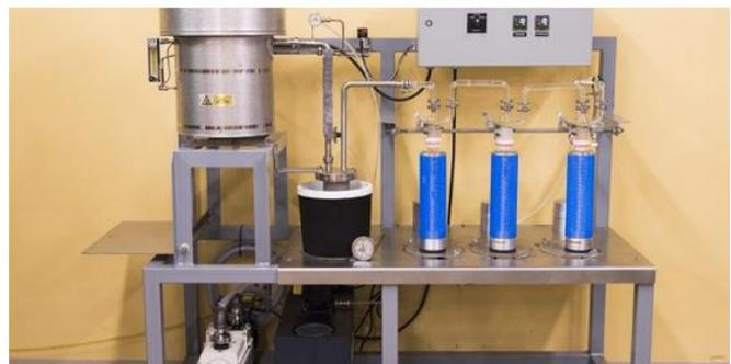
Cet équipement est principalement impliqué dans la chaîne de valeur du recyclage des fibres de carbone, dans le but d'une réutilisation dans un nouveau produit. Le réacteur permet de récupérer des fibres de bonne qualité ainsi qu'une huile de pyrolyse.
